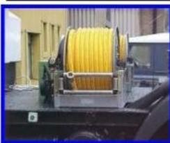
Carrete de manguera (50m) con rebobinado eléctrico con conectores de desconexión rápida y guía de manguera.
