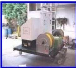
Modulo motor y bomba instalado en la plataforma con panel control y 2 carretes de manguera con rebobinado eléctrico
