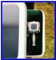
Control de una sola mano en la plataforma facilita un mando total de cualquier maniobra del brazo articulado
