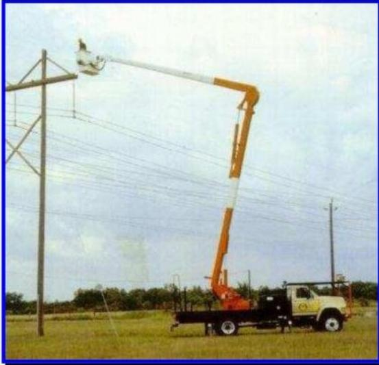
LA UNIDAD LAVADORA DE AISLADORES CON BRAZO ARTICULADO RANGER puede colocarse en una amplia variedad de tipos de bastidores para adecuarse a cualquier aplicación. Es disponible con un modulo motor y bomba para el lavado de aisladores instalado en una plataforma y un tanque de agua removible con capacidad de hasta 10,000 litros con 4 opciones principales de brazos articulados para trabajos en alturas de 14; 16; 20.5 y 22m.
