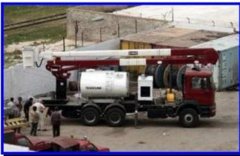
Este dispositivo de dos brazos articulados actúa en combinación con la unidad Lavadora de Aisladores TRANSLINK montada en Plataforma y un tanque de agua proporcionándole un Camión Lavador de aisladores con Brazo Articulado totalmente integrado con capacidad para lavar aisladores hasta 500kV. El brazo articulado cumple con las normas ANSI A92.2 Categoría "C" (46kV) y el Lavador de Aisladores cumple con las Normas internacionales IEEE-957 - opcionalmente Categoría B (69kV).
